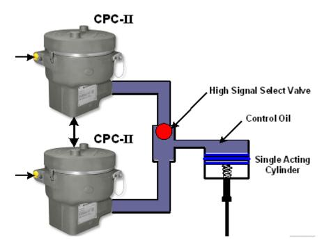
Figure 1-9. Redundant actuators
